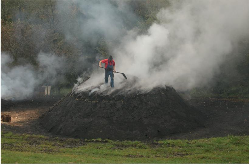
Abb. 23: Köhlerei Reinhold Wagner in Netphen-Walpersdorf 2010: Der Köhler reguliert die Verweilung derzeit durch das Verschließen von Zuglöchern in der Abdeckung des Meilers. Der Meilerschacht befindet sich mittig und ist im abgedeckten Zustand hier nicht einsehbar (Foto: Ruhr-Universität Bochum/M. Zeiler).
